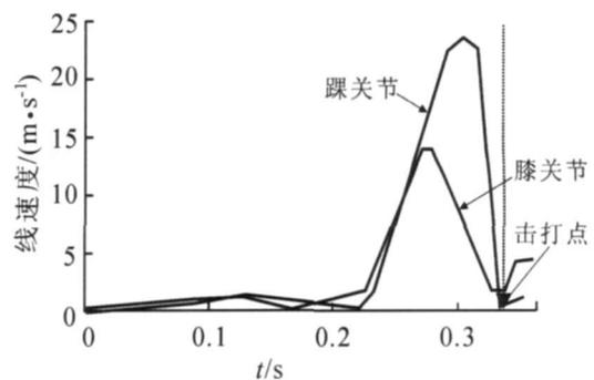
图 4 后腿踝关节膝关节时间—速度
